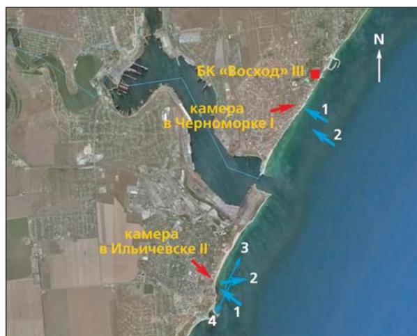
Примерное расположение пунктов видеосъемки (красными стрелками показано направление съемки) на пляжах Черноморки (I), Ильичевска (II) и берегового комплекса «Восход» в пос.Совиньон (III). Голубыми стрелками обозначены направления и последовательность движения водных масс у берега.
